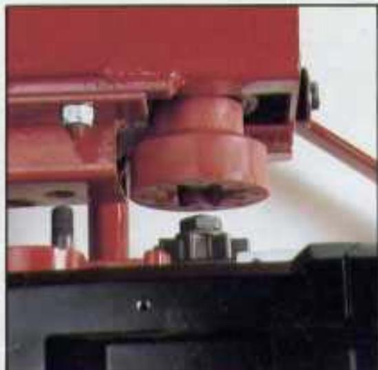
Das Wechseln von Säge zu Winde ist einfach und dauert nur 3 Minuten. Schiene, Kette und Kettenraddeckel werden vom Motor abgeschraubt. Das Kettenöl bleibt im Tank, die Ölschraube wird zuge dreht. Der Motor wird an die Kupplung der Seilwinde gesteckt, die beiden Selbstsicherungsmuttern festgezogen und die Sicherheitsabdeckung fixiert. Die MULTI-KBF-SEILWINDE ist einsatzbereit.
